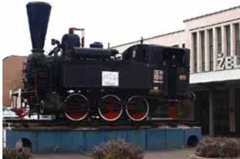
Lokomotivo je že dodobra načela rja
